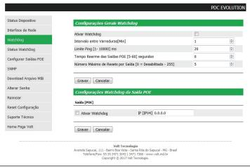
Apresenta a página de configuração dos parâmetros do WatchDog do dispositivo. Configurando o tempo de intervalos entre varredura, tempo de rearme das portas, limite ping, Número Máximo de resets por porta e ativar e desativar o WatchDog. Além dos campos para configuração do IP que será monitorado por porta e quais portas estarão com watchdog ativado.
