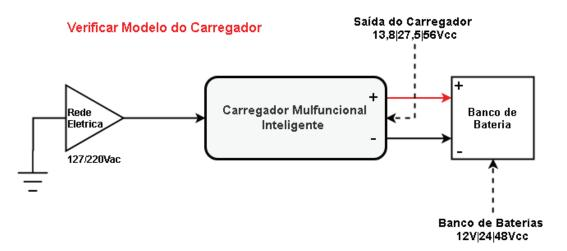
A imagem acima apresenta as ligações necessárias para instalação do Carregador Multifuncional Inteligente, para cada modelo de carregador deverá ser considerado um banco de baterias conforme as ligações da imagem 1(12|24|48Vcc).
